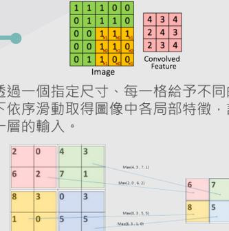
經過多次卷積與池化的過程後，將最後所得到的特徵輸入至Fully Connected Layer)進行分類及訓練，此即為 CNN 的典型作法。
