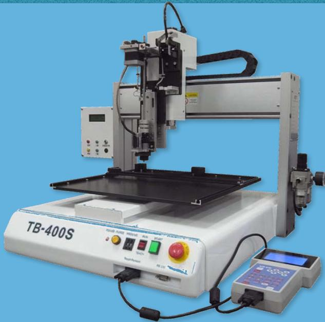
簡介：點膠機就是可以將流體點滴或塗覆於產品的自動化機器，為了提升良率和產能，我們的重點著重在軸控自動化與光學點補正這兩個部分。前者是設定完指令參數後，就能夠跑完全部指令，並能夠依需求將同樣指令作用於其他零件上；後者則是讓自動化執行中，因為種種因素出現的誤差能夠透過圖形辨識加以修正，藉此大大地增加良率。
