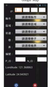
Figure.5.5 新增路燈 提供介面(Figure.10)用手機新增路燈， 需要手動輸入IP, ID, 在路燈序列中的位置，同時會自動添加GPS的訊息
